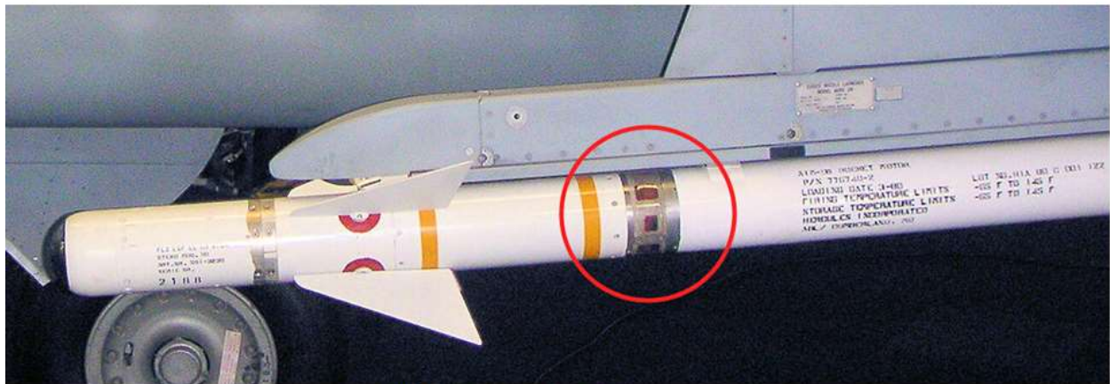
حسگر مجاورتی موشک هوا به هوای AIM-9B
