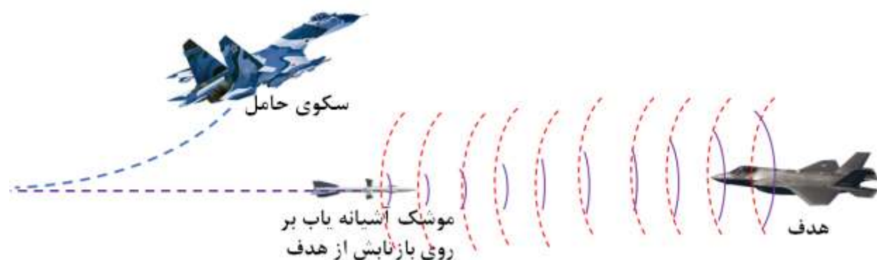
شکل ۸ هدایت آشیانه یاب فعال (مورد هوا-به-هوا)
